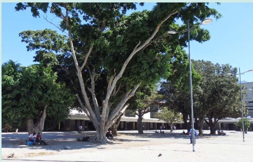
Dážďová voda je z vyspádovanej dláždenej plochy zvedená smerom ku stromom, pod ktorými je pre lepšiu vsiakavosť vysypaný štrk. Kapské mesto, Juhoafrická republika, Foto Veronika Knihová
