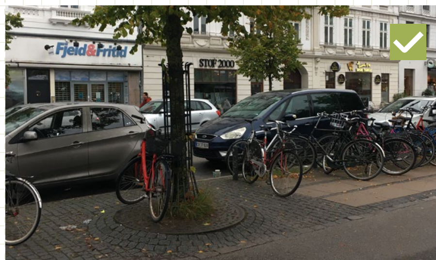
19 Trvalá vodorovná ochrana stromov pred pojazdom a parkovaním vozidiel v kombinácii so zvislou ochranou. Dánsko, Kodan
